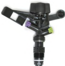
F22 - Aspersor plástico de círculo completo com bico de baioneta modelo standard para sistema fixo - conexão macho 1/2" (P=3 bar)
